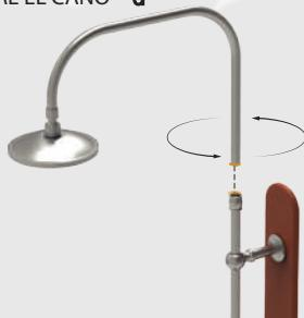
ASEGURESE DE ATORNILLAR EL SOPORTE AL PEDESTAL DE MADERA Y AJUSTE EL TORNILLO ALEM SUAVEMENTE
